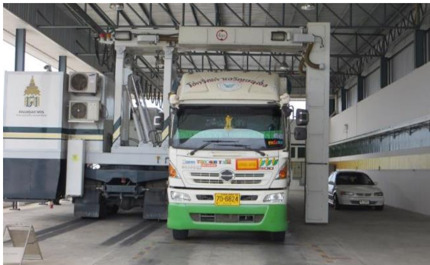
รูปที่ 8.30 สถานีตรวจสอบตู้สินค้าด้วยเครื่อง X-ray
