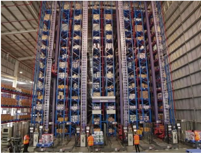
รูปที่ 6.25 ระบบจัดเก็บและหยิบสินค้าอัตโนมัติ (Automated Storage and Retrieval System)
