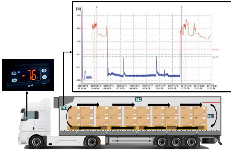
รูปที่ 4.8 ภาพรถบรรทุกแบบควบคุมอุณหภูมิและตัวอย่างกราฟบันทึกอุณหภูมิ
