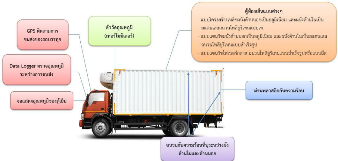
รูปที่ 4.17 องค์ประกอบรถตู้ห้องเย็น (ขั้นพื้นฐาน)
