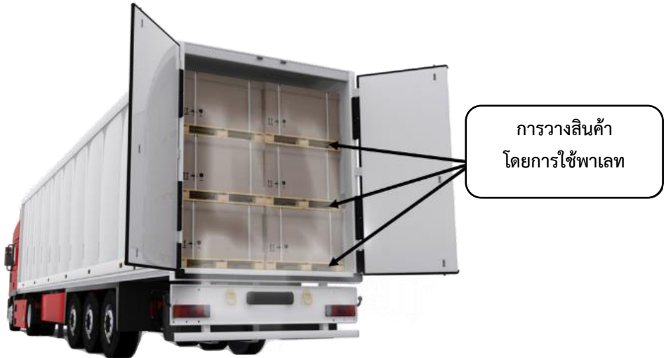
รูปที่ 4.6 ตัวอย่างการจัดเรียงสินค้าภายในตู้ห้องเย็น โดยใช้พาเลท
