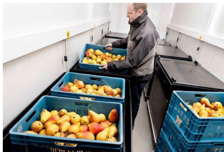
ภาพที่ 3.8 การทดลองการขนส่งสินค้าเกษตรด้วยห้องบรรจุสินค้าที่มีอุณหภูมิต่อสินค้าแต่ละชนิด ณ Wageningen University and Research Centre ประเทศเนเธอร์แลนด์
