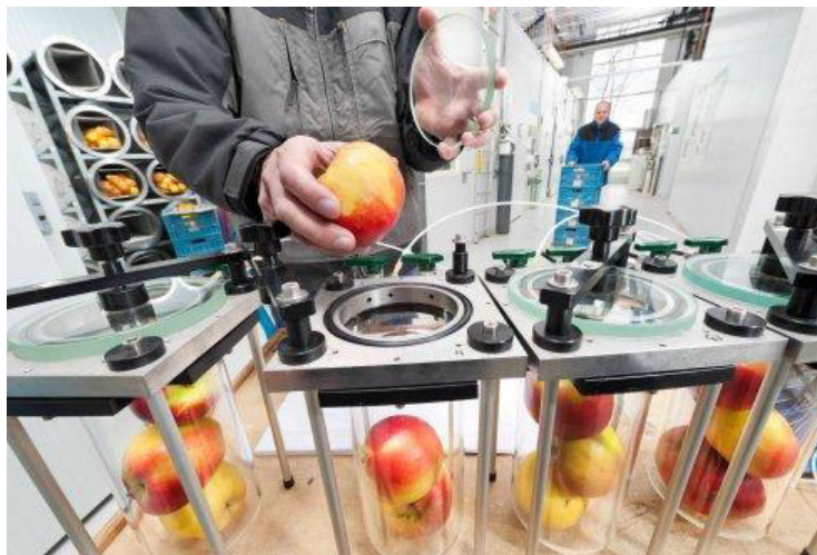
ภาพที่ 3.6 การทดลองการจัดเก็บผลไม้ในอุณหภูมิต่าง ๆ ณ Wageningen University and Research Centre ประเทศเนเธอร์แลนด์
