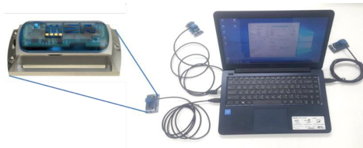
ภาพที่ 2.3 เครื่อง Data Logger for Shock และ Vibration Model MSR165 ที่มา: รวบรวมข้อมูลโดยคณะที่ปรึกษา (2561)
