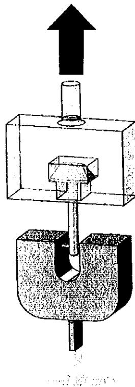
ภาพที่ ๕ การทดสอบแรงดึง
