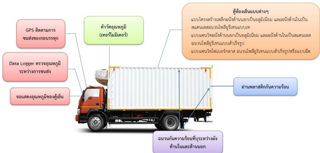
รูปที่ 1.3 องค์ประกอบพื้นฐานของรถบรรทุกแบบควบคุมอุณหภูมิ
